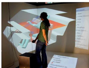
Рис. 3. Система WorkBench візуалізації сцен 3D віртуальної реальності в машинобудуванні [10]
