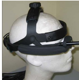
Рис. 8. Монокулярна система візуалізації Trivisio Monocular M3
