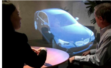
Рис. 5. EON Holographic – голографічна система відтворення в просторі 3D-зображення [2]
