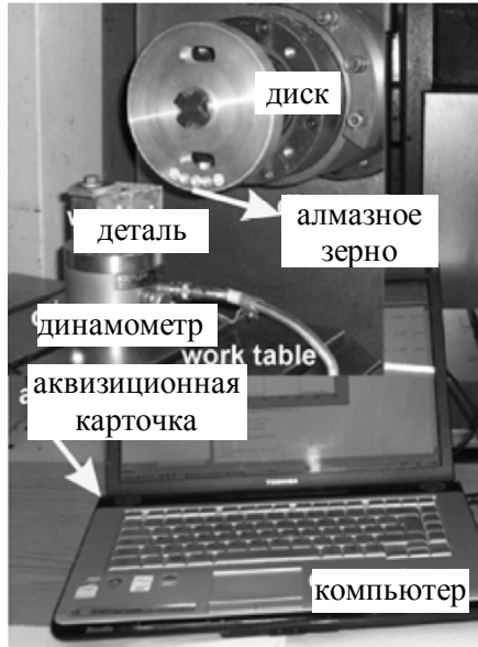
Рис. 2. Установка для измерения сил микрорезания
