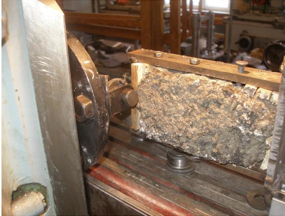
*Рис. 2. Процес фрезерування асфальта*
