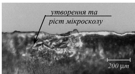
Рис. 2. Характер зношування задньої поверхні ножа фрези ( V = 23,5 м/с; S_z = 0,1 мм/зуб.; t = 1,5 мм) 90X: а) зародження мікросколу; б) ріст мікроскопу
